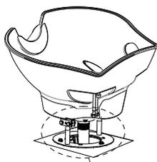
Para regular o reclinado da cuba, retirar a tampa traseira e apertar ou soltar os quatro parafusos conforme indicação na gura abaixo.
