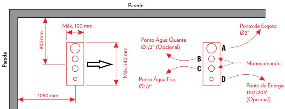
**A (Ponto de Esgoto Ø2")**- Altura ideal para encanamento referente ao piso é de 50mm.
