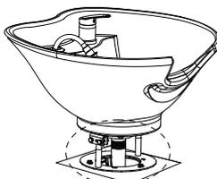
Para regular o reclino da cuba, retirar a tampa traseira e apertar ou soltar os quatro parafusos conforme indicação na gura abaixo.
